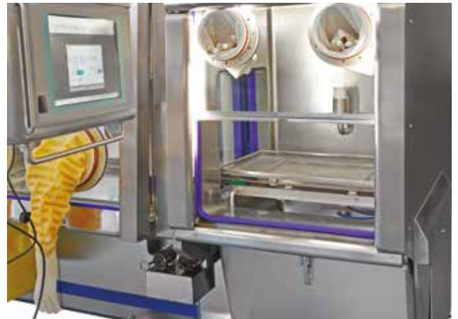
H 2 O 2 sterilizálás - sterilizálható az egész fülke, az inkubátor vagy csak a kamra.
