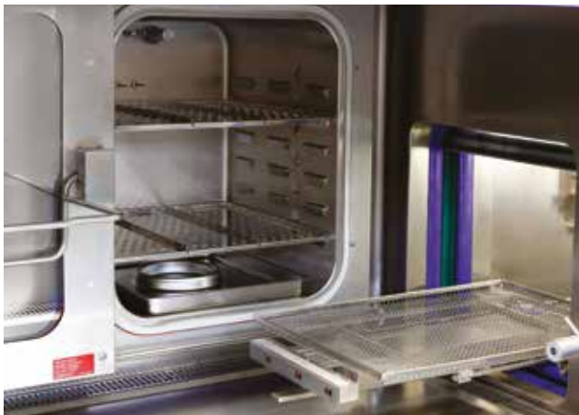
Integrált CO 2 inkubátor fülke vezérlésével. Hozzáférés a fülke munkafelületén keresztül.
